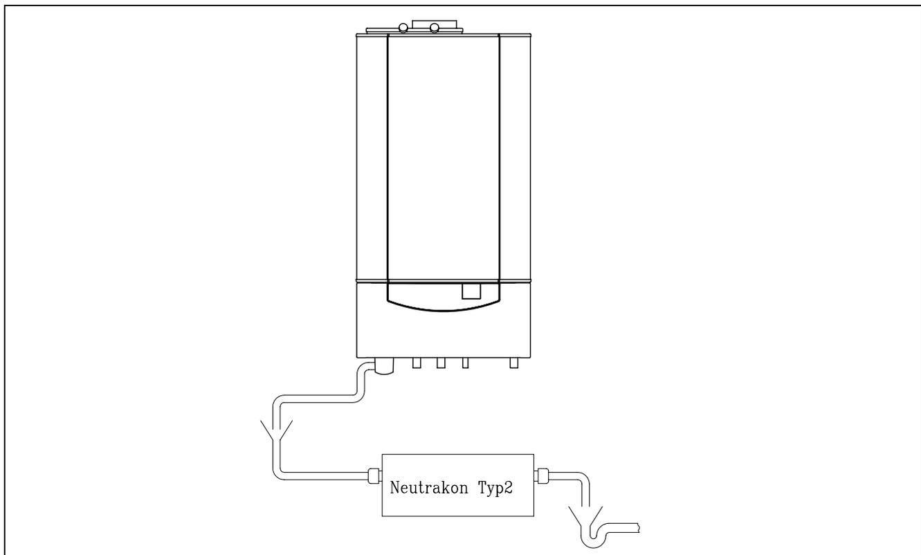
**Bild 08 Kondenswasserableitung**
