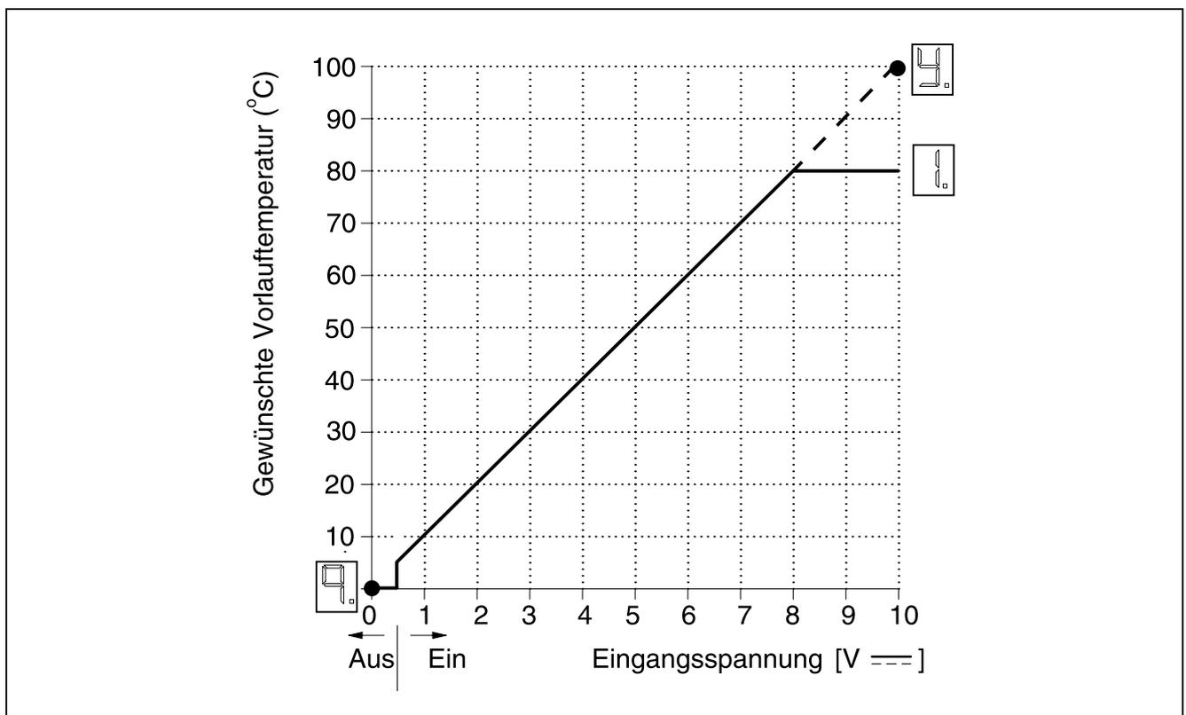
Bild 12 Zusammenhang zwischen Eingangsspannung und Kesselvorlauftemperatur
