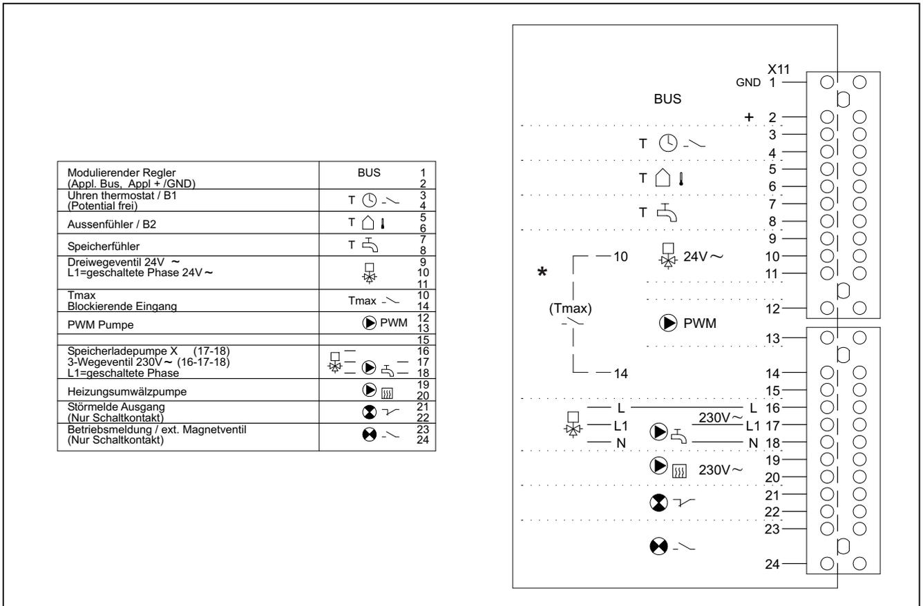
**Bild 10 Elektrische Anschlüsse (Kesselklemmleiste)**
