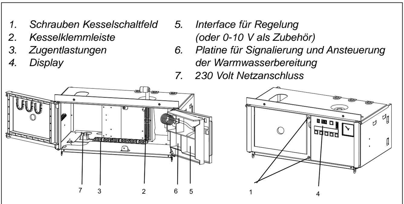
**Bild 11 Übersicht Kesselschaltfeld**
