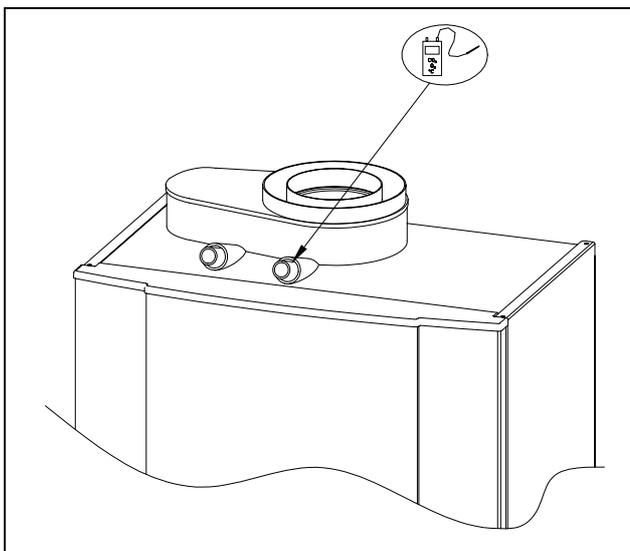
**Bild 18** Abgasmesspunkt
