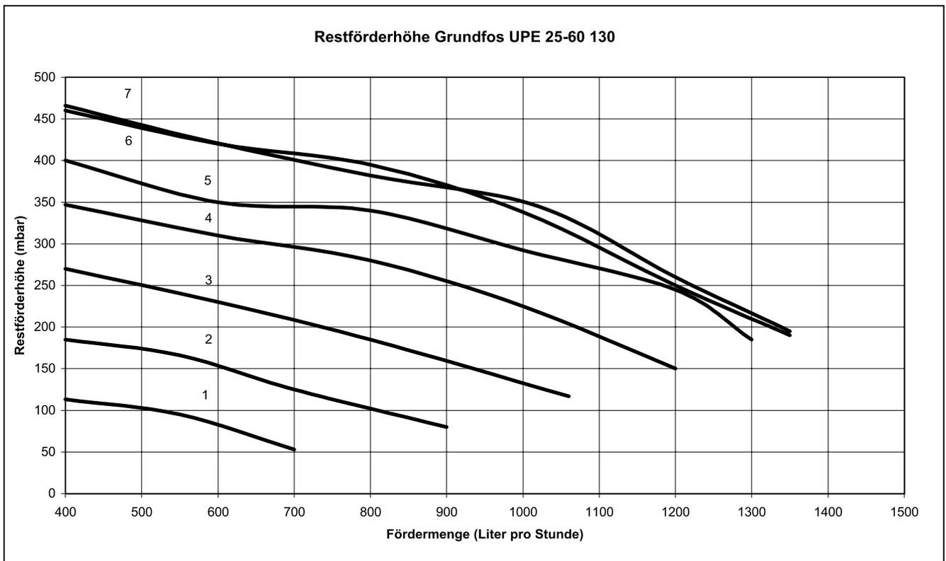
Bild 07 Verfügbaren Restförderhöhe Remeha Quinta 10/25
