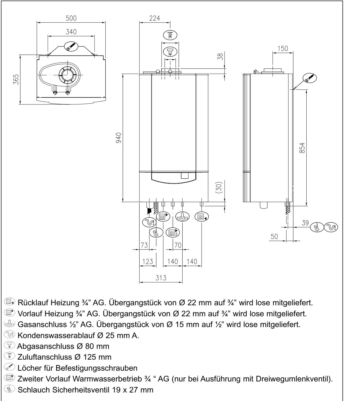
**Bild 02** Abmessungen Remeha Quinta 10/25/30
