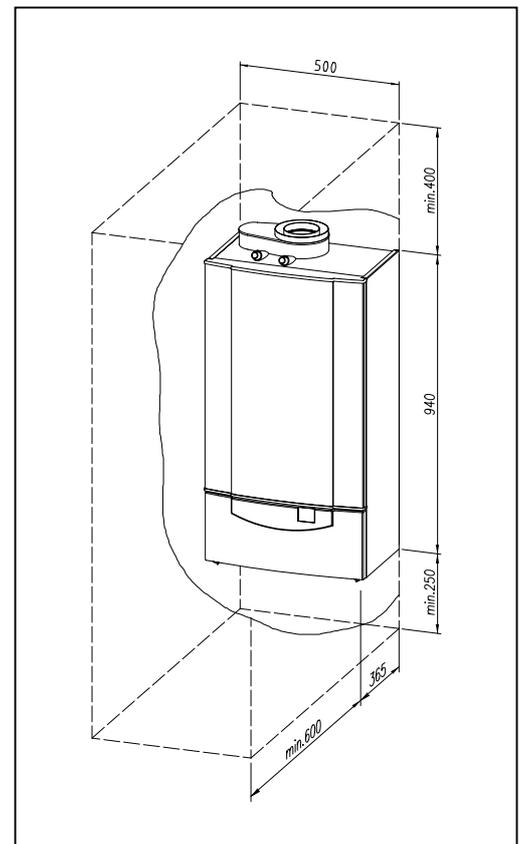
**Bild 06 Platzbedarf für Montage**
