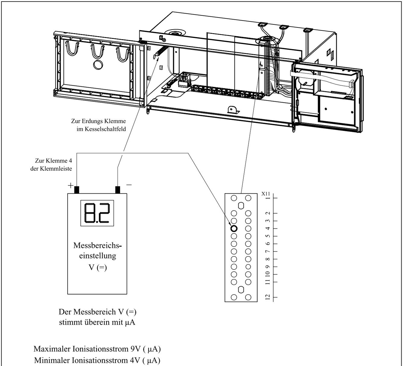
**Bild 17 Ionisationsmessung**
