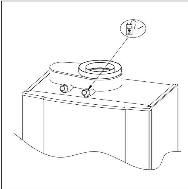
**Bild 15 Abgasmesspunkt**
