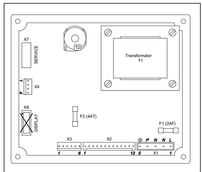
**Bild 09 Kesselautomat Gasmodul**
