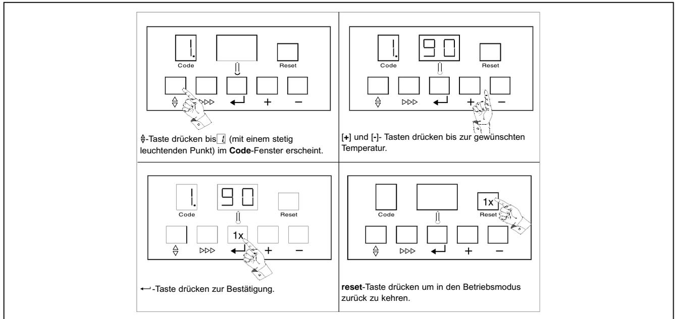
Bild 05 Einstellung gewünschte maximale Kesselvorlauftemperatur
