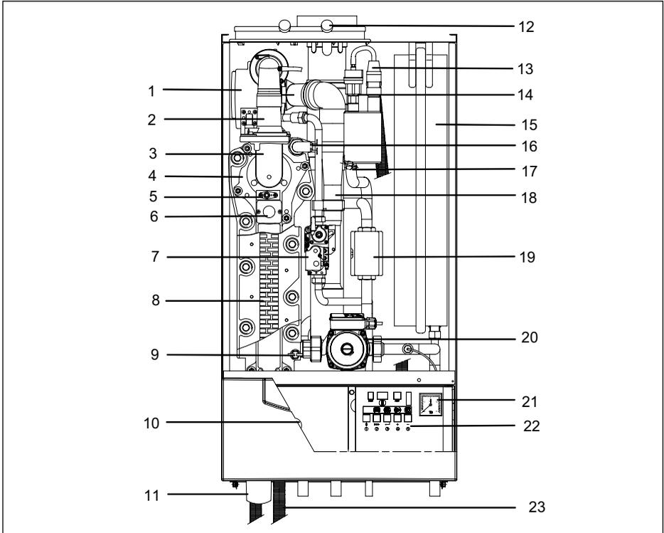
Bild 01 Anordnung der Bauteile.
