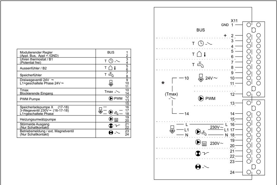
**Bild 10 Elektrische Anschlüsse (Kesselklemmleiste)**
