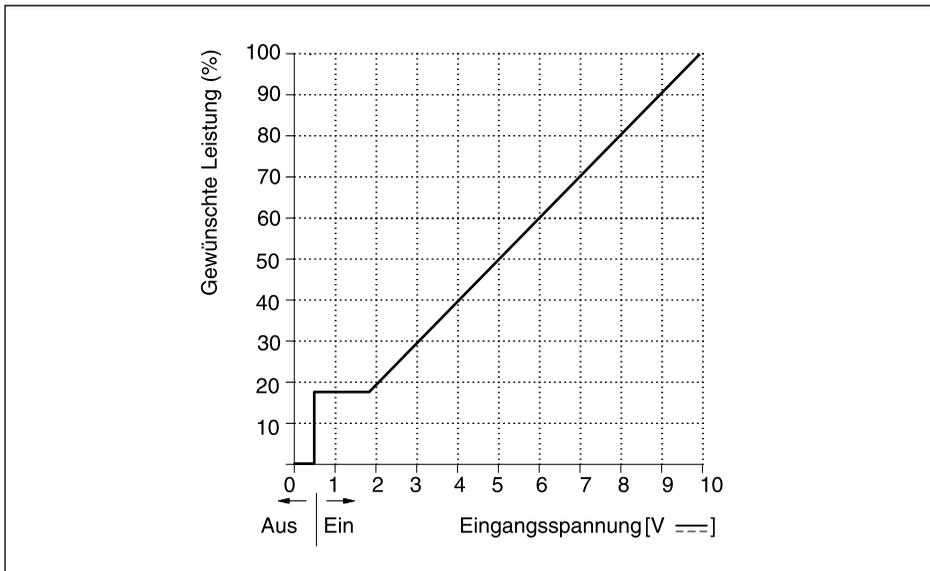
*Bild 13 Zusammenhang zwischen Eingangsspannung und Belastung (Quinta 30)*
