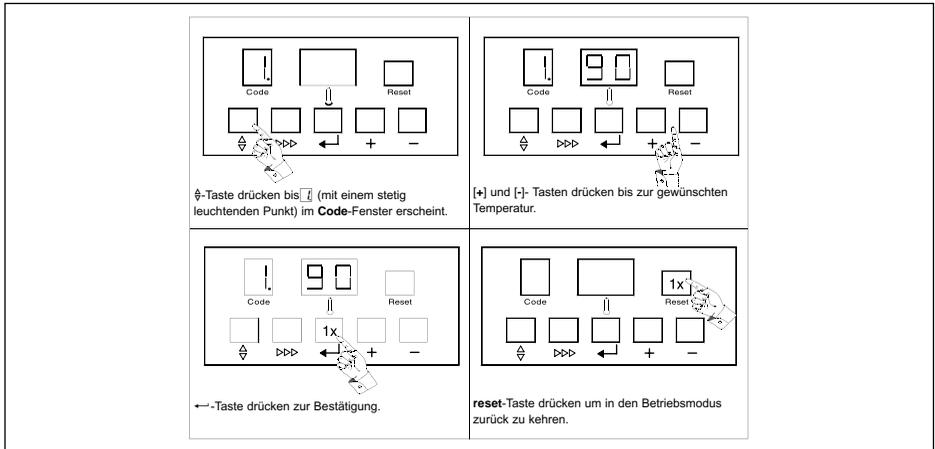
**Bild 05** Einstellung gewünschte maximale Kesselvorlauftemperatur
