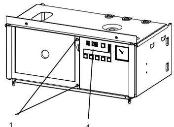
**Bild 11 Übersicht Kesselschaltfeld**
