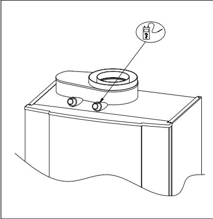
Bild 15 Abgasmesspunkt
