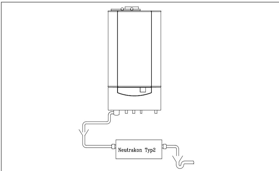
**Bild 08 Kondenswasserableitung**
