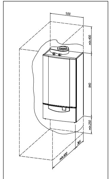
**Bild 06 Platzbedarf für Montage**
