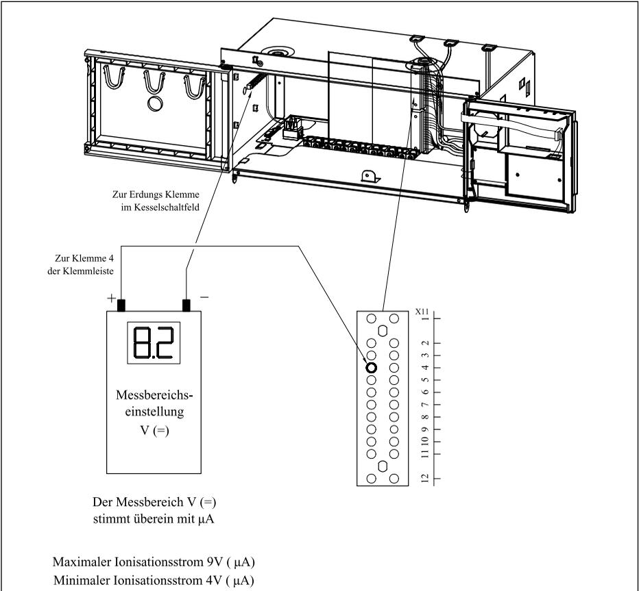
**Bild 17 Ionisationsmessung**
