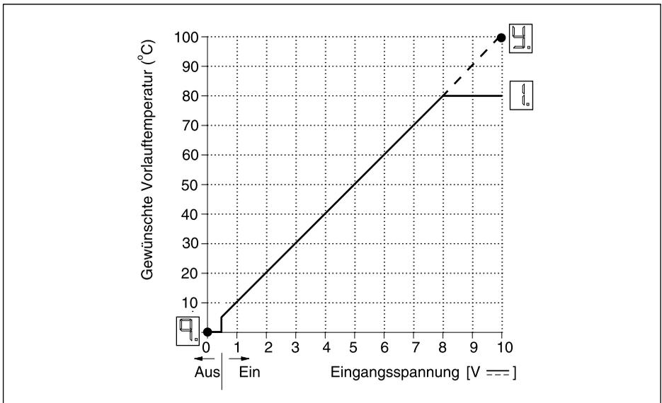
Bild 12 Zusammenhang zwischen Eingangsspannung und Kesselvorlauftemperatur
