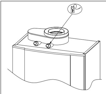
Bild 18 Abgasmesspunkt
