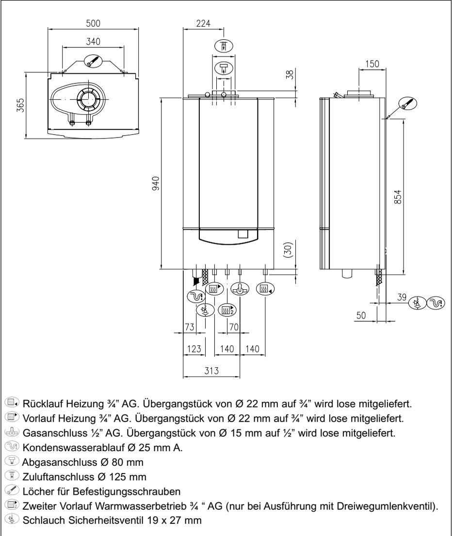
**Bild 02** Abmessungen Remeha Quinta 10/25/30
