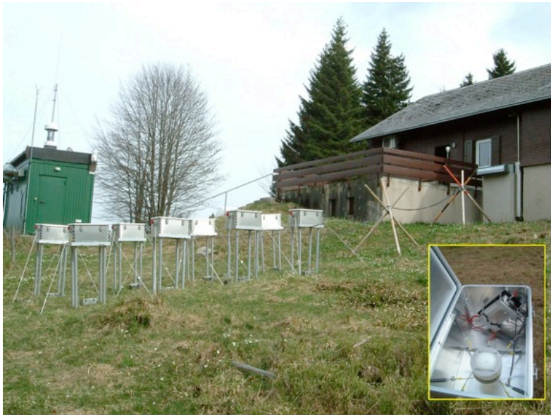
Abbildung 1 b: SIL : BFS (Bundesamt für Strahlenschutz) Messstation für atmosphärische Radioaktivität auf dem Schauinsland
