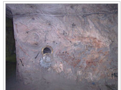
Versuchsbohrung für ein Wärmeleitfähigkeitsexperiment im Steinsalz. Solche Versuche wurden zwischen 1967 und 1995 auf der 490-m-, 750-m- und 775-m-Sohle durchgeführt.
