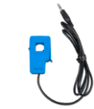
Stromsensor 100 A: 50 mA Zur Umsetzung der PowerControl und PowerAssist Funktionen und zur Optimierung des Eigenverbrauchs mit externer Strommessung. Maximaler Strom: 50 A bzw. 100 A. Länge des Anschlusskabels: 1 m
