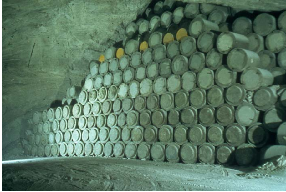
VBA's in Kammer 6 der 750 m - Sohle
